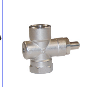
manometerkraan PN4 met drukknop en veer fig 698 : 1/4FF of 1/2"FF bps huis in messing vernikkeld max. temp. : +120°C
