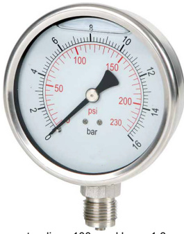
manometer diam. 100 mm klasse 1,6 fig 672 : 0 - 2,5/4/6/10/16/25/40/60/100 bar dubbele schaal in psi glycerine gevuld kast inox 304 aansluiting / bourdon in inox 316 1/2" bsp radiaal aansluiting (onder)
