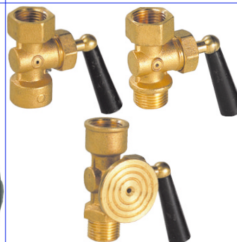
manometerkraan PN16 huis in messing max. temp. : +120°C fig 690 : 1/2" FF bsp fig 691 : 1/2" MF bsp fig 696 : 1/2" MF bsp met proefflens
