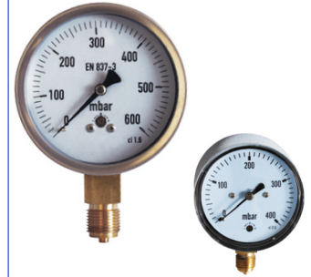
manometers in mbar druk : 0 - 60/100/250/400/600 mbar droge uitvoering aansluiting en binnenwerk in messing kast inox 304 fig 668 : klasse 1,6 / 1/2" bsp radiaal (onder) diam. 100 mm fig 658 : klasse 1,6 / 1/4" bsp radiaal (onder) diam. 63 mm
