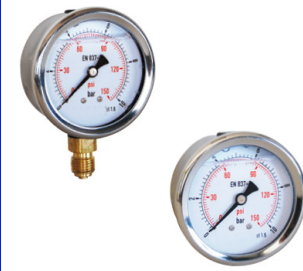
manometer diam. 63 mm klasse 1,6 vacuüm : -1 +1 bar druk : 0 - 1,6/2,5/4/6/10/16/25/40/60 bar druk : 0 - 100/160/250/400 bar - psi schaal glycerine gevuld aansluiting en binnenwerk in messing kast inox 304 fig 660 : 1/4" bsp radiaal (onder) fig 661 : 1/4" bsp axiaal (achter)
