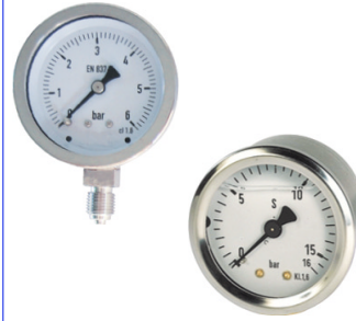
manometer diam. 63 mm klasse 1,6 vacuüm : -1 +1 bar druk : 0 - 1,6/2,5/4/6/10/16/25/40/60 bar fig 662 : droge uitvoering 1/4" bsp radiaal fig 663 : glycerine gevuld 1/4" bsp axiaal aansluiting / bourdon in inox 316 kast inox 304
