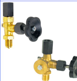
manometerkraan hoge druk PN250 voorzien van wartel huis in messing / wartel in staal max. temp. : +120°C aansluiting 1/2" MF bsp fig 692 : standaard uitvoering fig 697 : uitvoering met proefflens
