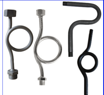
sifonpijp PN25 fig 680 : stalen uitvoering zonder wartel 1/4MM of 1/2"MM bps fig 681 : stalen uitvoering U-type zonder wartel 1/4MM of 1/2"MM bps fig 682 : inox uitvoering met wartel fig 683 : koperen uitvoering met wartel 1/4MM of 1/2"MM bps
