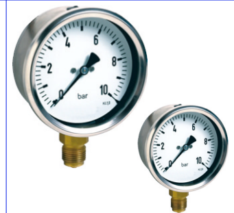
droge manometers klasse 1,6 druk : 0 - 1/2,5/4/6/10/16/25 bar aansluiting en binnenwerk in messing kast inox 304 fig 667 : 1/2" bsp radiaal (onder) diam. 100 mm fig 657 : 1/4" bsp radiaal (onder) diam. 63 mm
