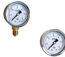
manometer diam. 50 mm klasse 2,5 vacuüm : -1 +1 bar druk : 0 - 1,6/2,5/4/6/10/16/25/40/60 bar glycerine gevuld aansluiting en binnenwerk in messing kast inox 304 fig 653 : 1/4" bsp radiaal (onder) fig 654 : 1/4" bsp axiaal (achter)
